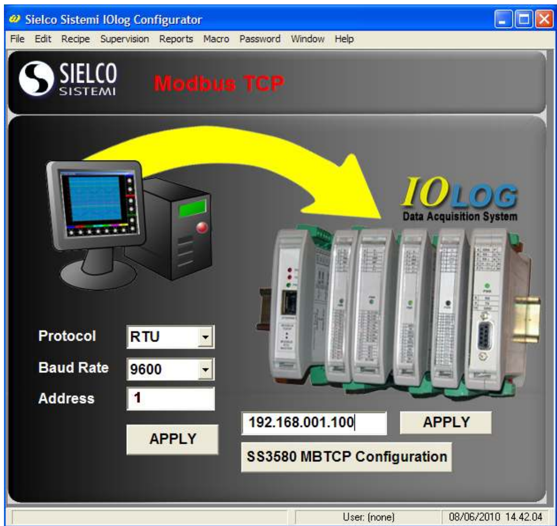
Configurazione di un modulo su linea ethernet (Modbus TCP)
